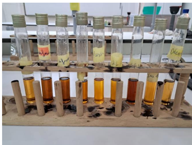
Figure 6: tubes contenant les complexes colorés résultants de la condensation des dérivés H_2SO_4 avec le phénol et Stevia
