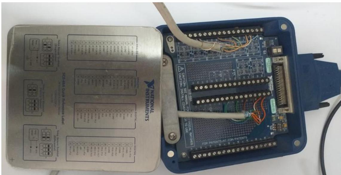
Figure III .12. Carte d'acquisition PCIe6351
