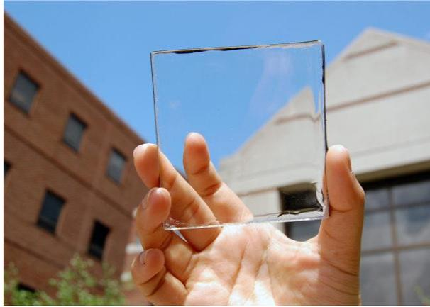
Figure I.10. Les cellules solaires photovoltaïques transparentes
