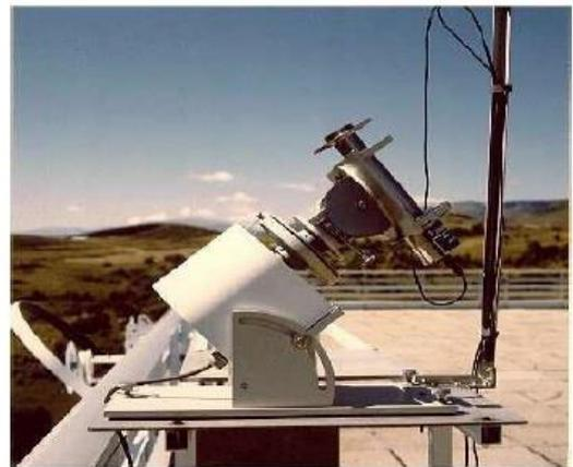
Figure I.3 : Pyréliomètre pour la mesure du rayonnement direct.
