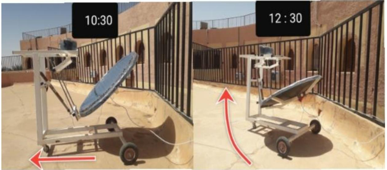
Figure III.3 : Vue du cuiseur parabolique lors d'un test du mois de Mai 2021 pris à deux heures différentes à 10:30h AM et 12:30h AM.
