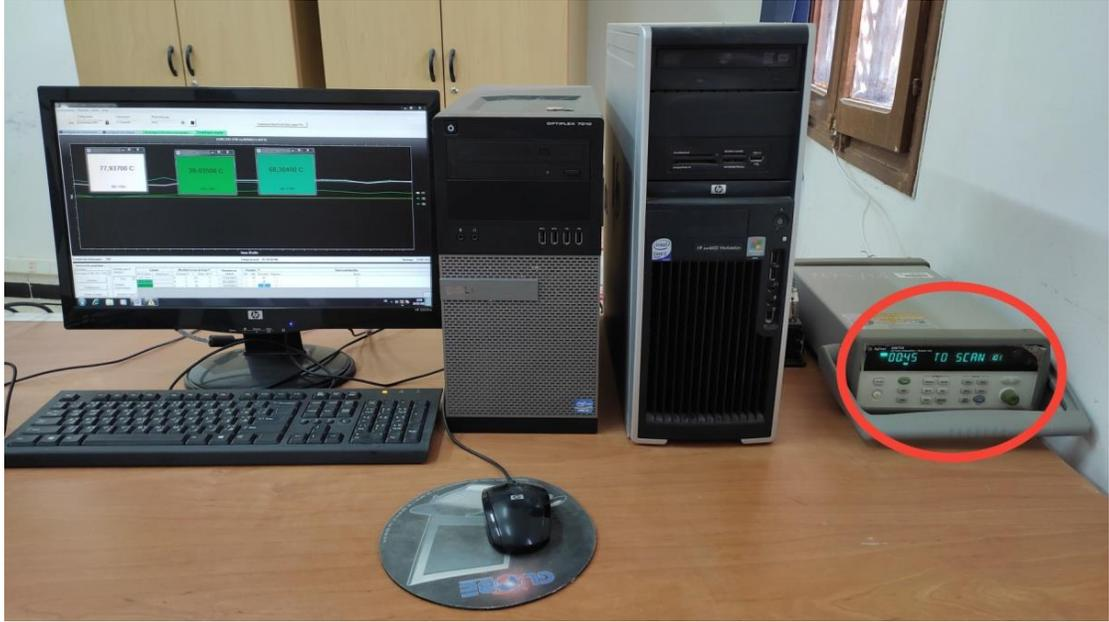
Figure III.5 : Visualisation des températures sur un micro-ordinateur connecté à une unité d'acquisition de donnée.
