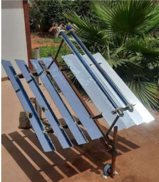
Fig.III.7 : Réflecteur composé de deux tubes sous-vides et des miroirs réfléchissants.
