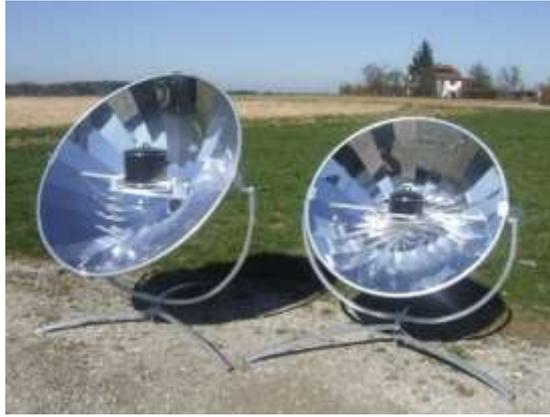
Fig. I.9 : Le cuiseur parabolique [19].
