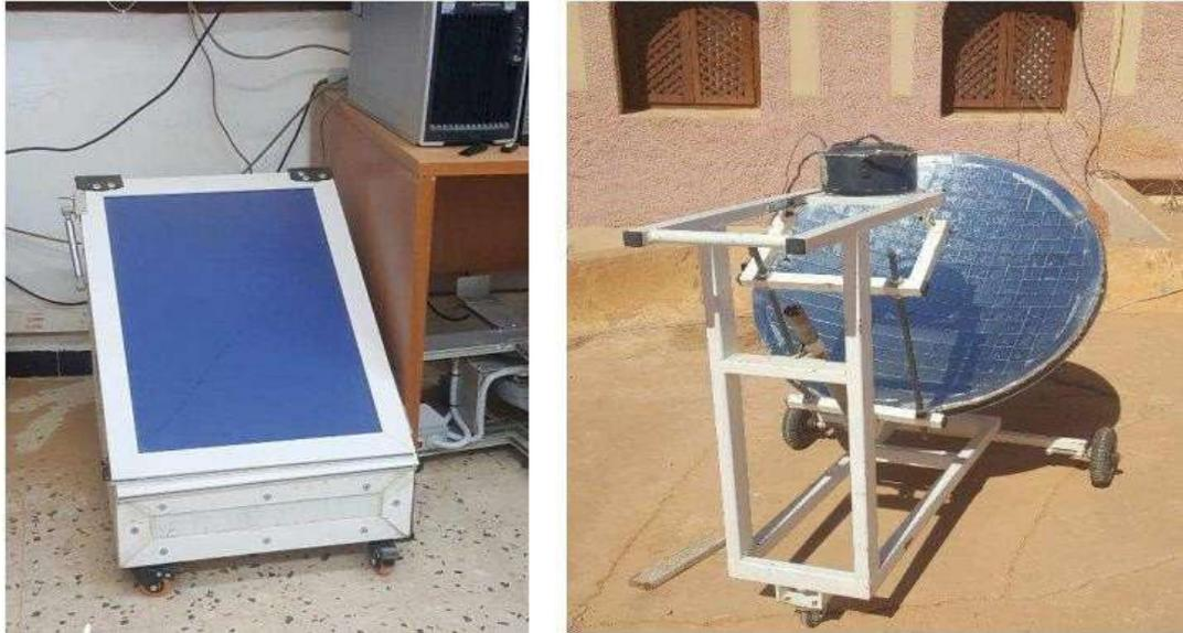
Fig. I.5 : Deux prototypes de cuiseurs solaires réalisés et testés à l'URAER Ghardaïa [2].
