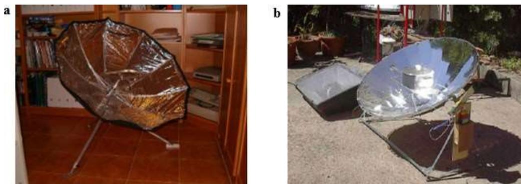
Fig. I.12 : (a) Cuiseur parapluie réalisé par José M. Arenas, (b) cuiseur parabolique réalisé par Grupp et al.
