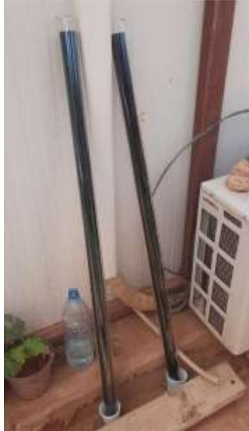
Fig.III.9 : Vue des deux tubes sous vides utilisés pour notre cuisinier.
