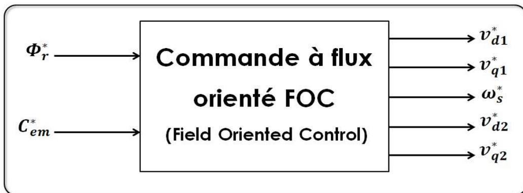
Figure III.2: Schéma bloc simplifié de la commande à flux orienté (FOC)
